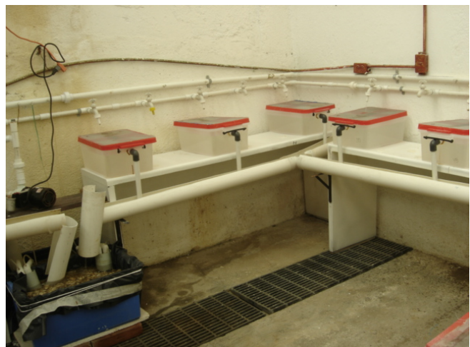
Figura 3. Detalle del sistema de recirculación utilizado en el ensayo que muestra las unidades experimentales, la bomba y los contenedores de filtrado.
